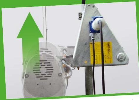
Integrierter Endschalter schaltet bei Erreichen des Auslegers, Überladung und Hängenbleiben am Gerüst ab
